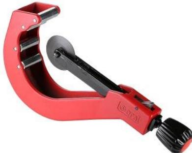
(VTr.788.0) Инструмент предназначен для резки однослойных и армированных полипропиленовых труб диаметром 50-110 мм. Роликовый резак обеспечивает ровный, без скоса, срез трубы. Во время работы трубу рекомендуется фиксировать на монтажном столе. Для резки труб из других материалов данный инструмент не используется.
