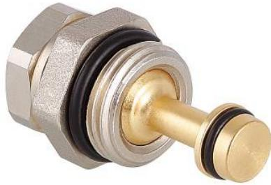
(VT.VDC31.N) Настроечный клапан (регулировочный клапан) для коллекторного блока VTc.594. Служит для гидравлической балансировки петель при наладке водяного теплого пола или радиаторного отопления. Не предназначен для использования в качестве запорного клапана. **Таблица совместимости коллекторных блоков и комплектующих** \*подходит только для коллектора «обратки»
